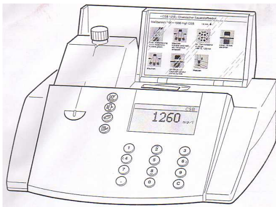
Εικόνα 7: Φωτόμετρο MERCK Spectroquant® NOVA60 το οποίο χρησιμοποιήθηκε για τη μέτρηση των kit του COD και άλλων kit.
