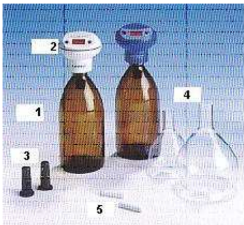
Εικόνα 9 : Μπουκάλια (1), κεφαλές- ψηφιακοί αισθητήρες αισθητήρες (2), θήκες από καουτσούκ (3), ογκομετρική φιάλη υπερχειλίσσης όγκου 428 ml και 157 ml (4) μαγνητικές ράβδοι ανάδευσης (5) (Lonibond) για τη μέτρηση του BOD.
