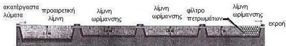
(β) Σύστημα λιμνών σταθεροποίησης αποβλήτων
