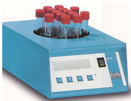
Εικόνα 8: Θερμοαντιδραστήρας της εταιρίας VELP, ο οποίος χρησιμοποιήθηκε στην διαδικασία μέτρησης του COD.
