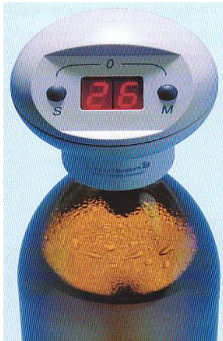
Εικόνα 11: Μπουκάλι και κεφαλή- ψηφιακός αισθητήρας (Lonibond) που χρησιμοποιήθηκαν για τη μέτρηση του BOD.
