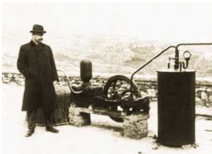
Σχήμα 3: Η μηχανή που χρησιμοποιήθηκε στο Larderello το 1904 κατά την πρώτη πειραματική απόπειρα παραγωγής ηλεκτρικής ενέργειας από γεωθερμικό ατμό. Διακρίνεται επίσης ο εφευρέτης της, πρίγκιπας Piero Ginori Conti.
