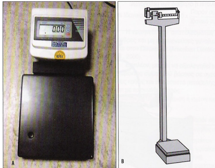
Εικόνα 4.7 Φωτογραφίες Α) ηλεκτρονικής ζυγαριάς και Β) ζυγού με δοκό ισορροπίας
