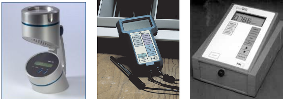
Εικόνα 6.2 Τα όργανα που χρησιμοποιήθηκαν κατά τις δειγματοληψίες. Από αριστερά προς τα δεξιά: 1) MAS 100 (Merck, Γερμανίας), 2) VelociCalc (TSI) και 3) Dust – Track (TSI).
