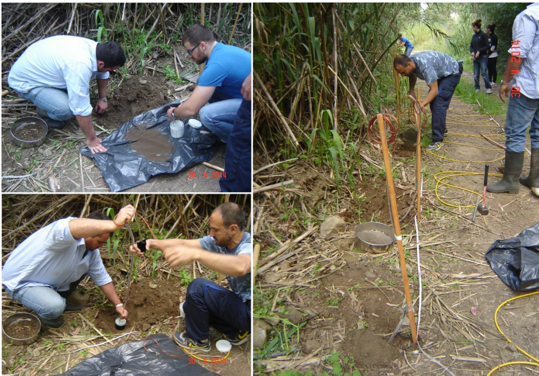
Σχήμα 5.3 Διαδικασία τοποθέτησης ηλεκτροδίων φυσικού δυναμικού στον Αλικιανό (Soupios and Karaoulis, 2015).
