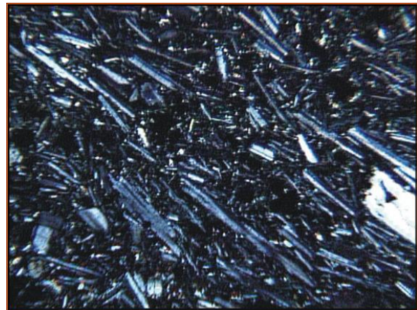
Σχ.160 Ρευστική υφή του βασάλτη. Αποτυπώνεται από την παράλληλη διάταξη των πλαγιόκλαστων στην υαλώδη κύρια μάζα, +Nicols.
