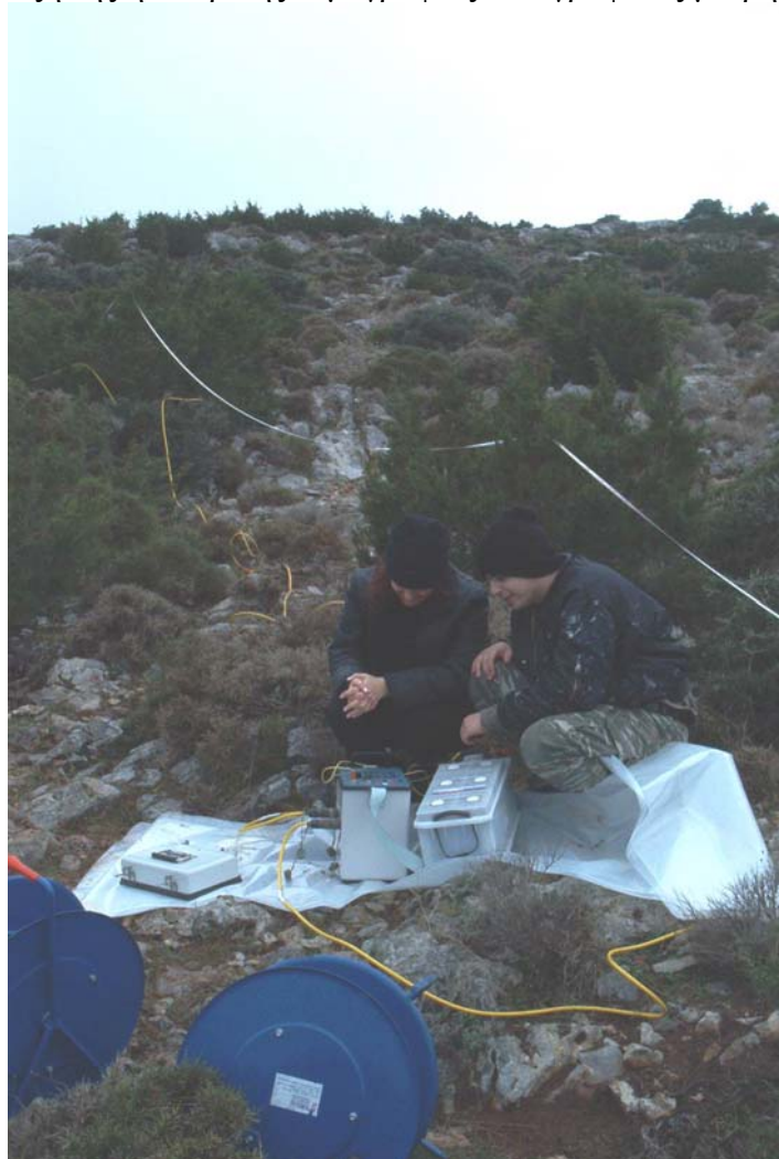
Σχήμα 128. Έλεγχος λειτουργίας του καταγραφέα και προσδιορισμός του χρόνου ολοκλήρωσης των μετρήσεων.
