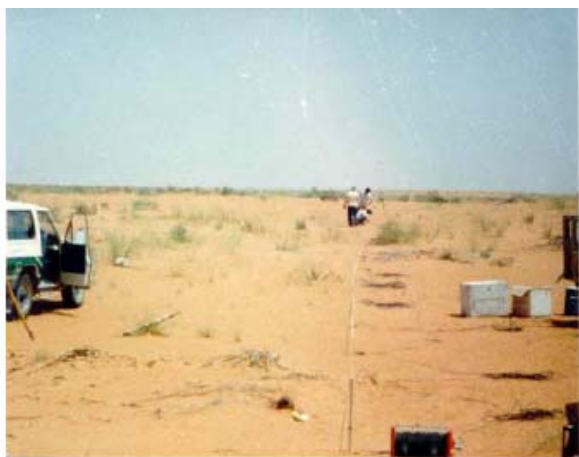
Γεωφυσικό συνεργείο του Τομέα Γεωφυσικής του Πανεπιστημίου Αθηνών σε εργασία απλώματος των γεωφώνων και του καλωδίου γεωφώνων στα πλαίσια σεισμικής έρευνας διάθλασης στην έρημο Dahna της Σαουδικής Αραβίας για τον εντοπισμό κοιτάσματος χαλκών (Saudi Government Railways Organization, Dammam 1981).
