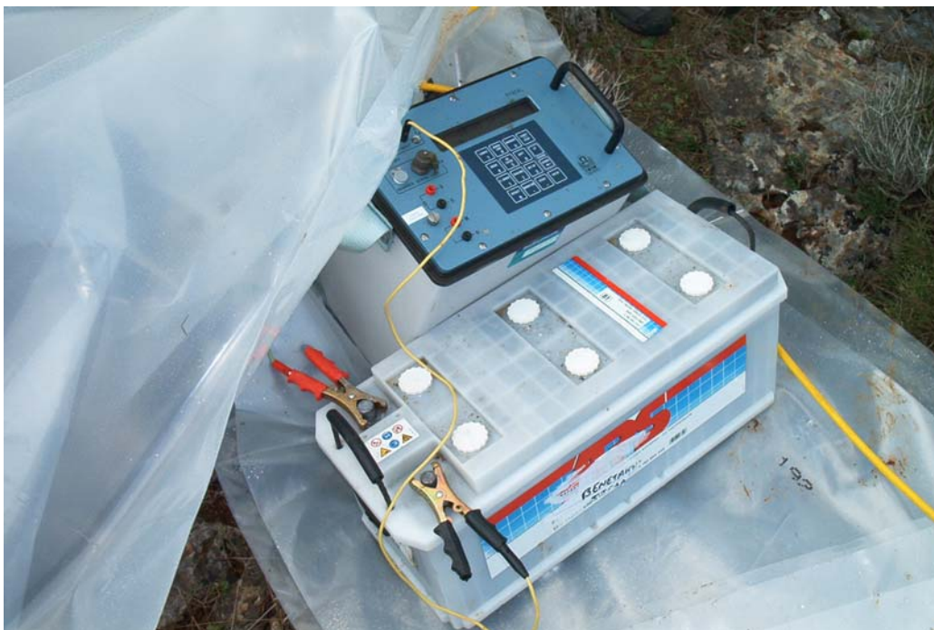
Σχήμα 126. Πλήρες σύστημα εκτέλεσης γεωηλεκτρικής τομογραφίας 48 καναλιών και δωδεκάβολτη μπαταρία.
