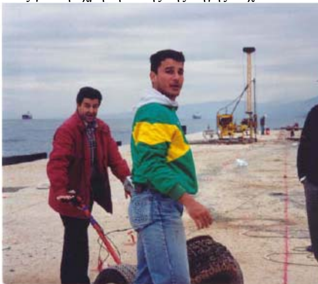
Γεωφυσικό συνεργείο του Τομέα Γεωφυσικής ενώ ρυμουλκεί συσκευή όπλου (Betsy Gun) στη προβλεπόμενη θέση διέγερσης σεισμικής πηγής σε πείραμα σεισμικής διάθλασης στη νησίδα Ρεβυθούσα (1997, Δημόσια Επιχείρηση Παροχής Αερίου, ΔΕΠΑ).
