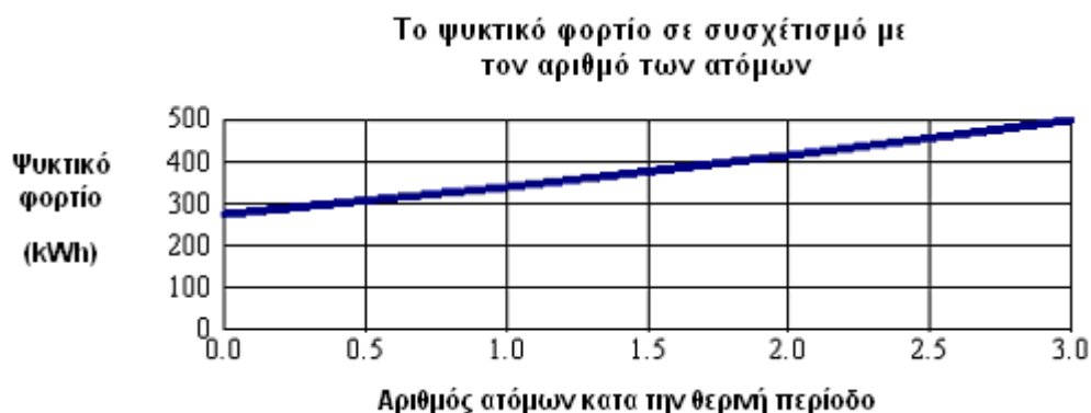
Διάγραμμα 8.2.1. Το ψυκτικό φορτίο του αναφορικού κτιρίου σύμφωνα με τον αριθμό των ατόμων την θερινή περίοδο
