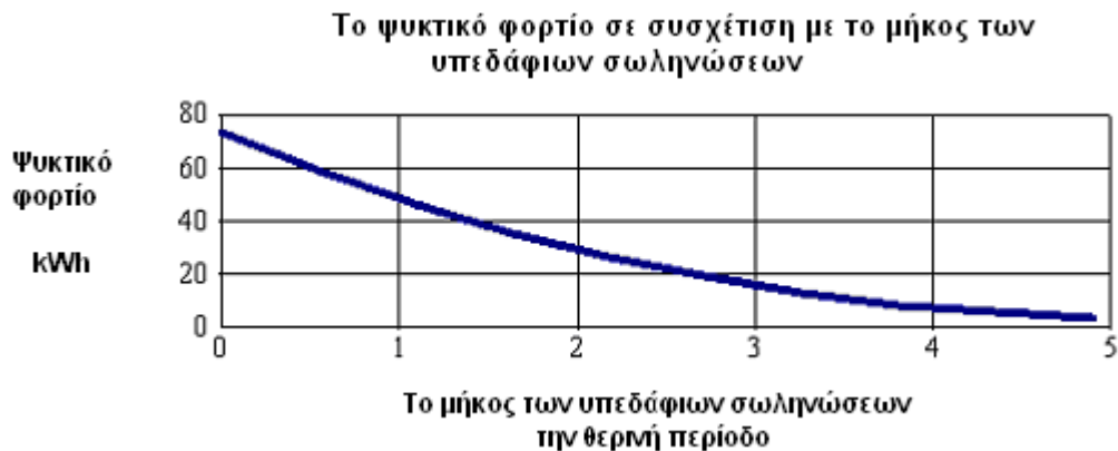
Διάγραμμα 8.4.2. Το ψυκτικό φορτίο σε A/C κτίριο σε σχέση με το μήκος των υπεδαφίων σωληνώσεων
