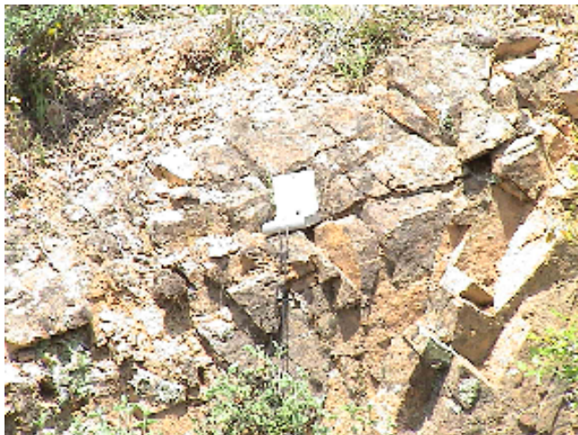
Φώτο 15, 16. Επιφανειακή εμφάνιση του γνευσιακού υποβάθρου στην Χ.Θ. 3+000. Ο γνεύσιος εμφανίζεται κατακερματισμένος.
