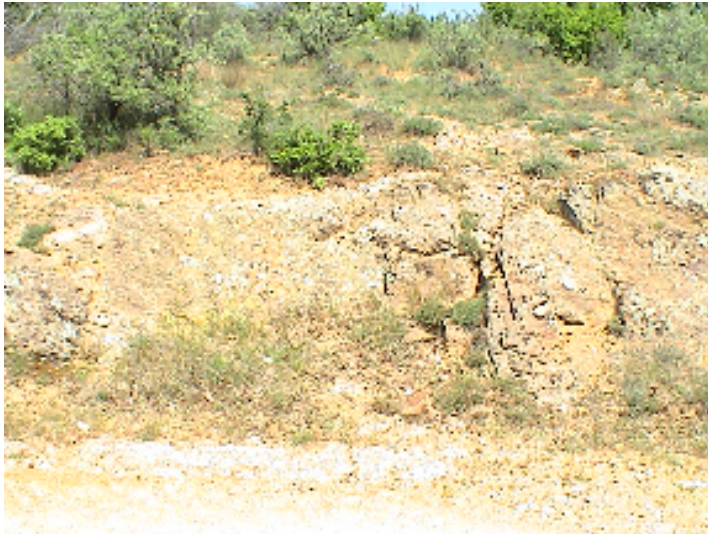
Φώτο 27, 28. Επιφανειακή εμφάνιση του γνευσιακού υποβάθρου στην Χ.Θ. 4+750.
