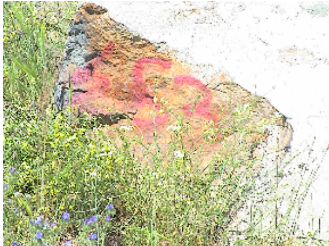
Φώτο 31. Επιφανειακή εμφάνιση περιδοτίτη στην Χ.Θ. 5+250. Φώτο 32. Θέση κατασκευής τεχνικού στην Χ.Θ. 5+500, στο τέλος του δρόμου.
