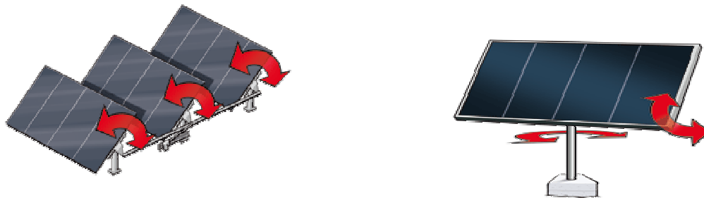
Εικόνα 3.1 α) κίνηση σε έναν άξονα β) κίνηση σε δυο άξονες
