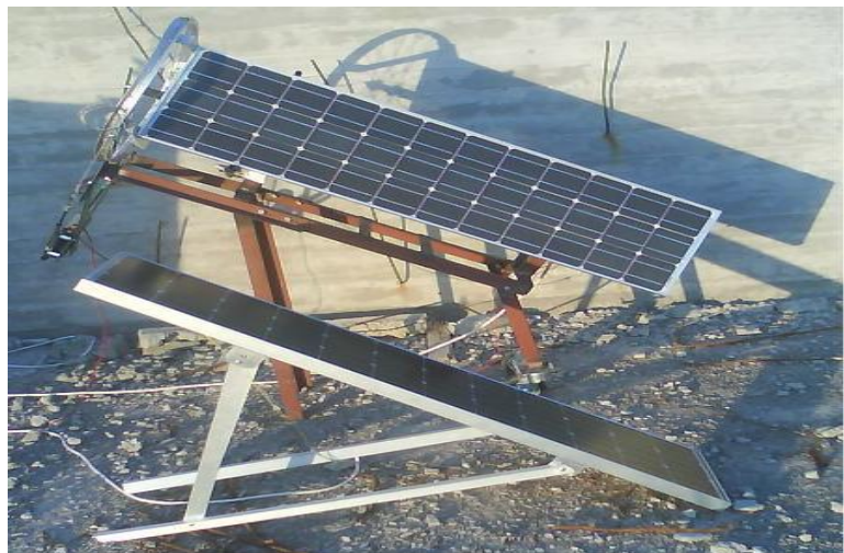
Σχ 4.7 Ημερησία λειτουργία tracker α) Ανατολή β) Μεσημέρι γ) Δύση
