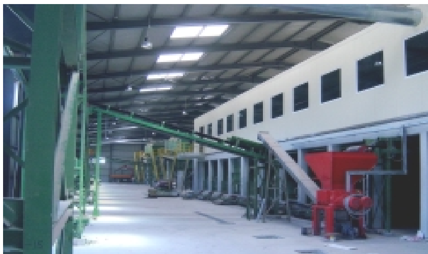
Εικόνα 5.2: Διάταξη ανάκτησης ανεπιθύμητων υλικών
