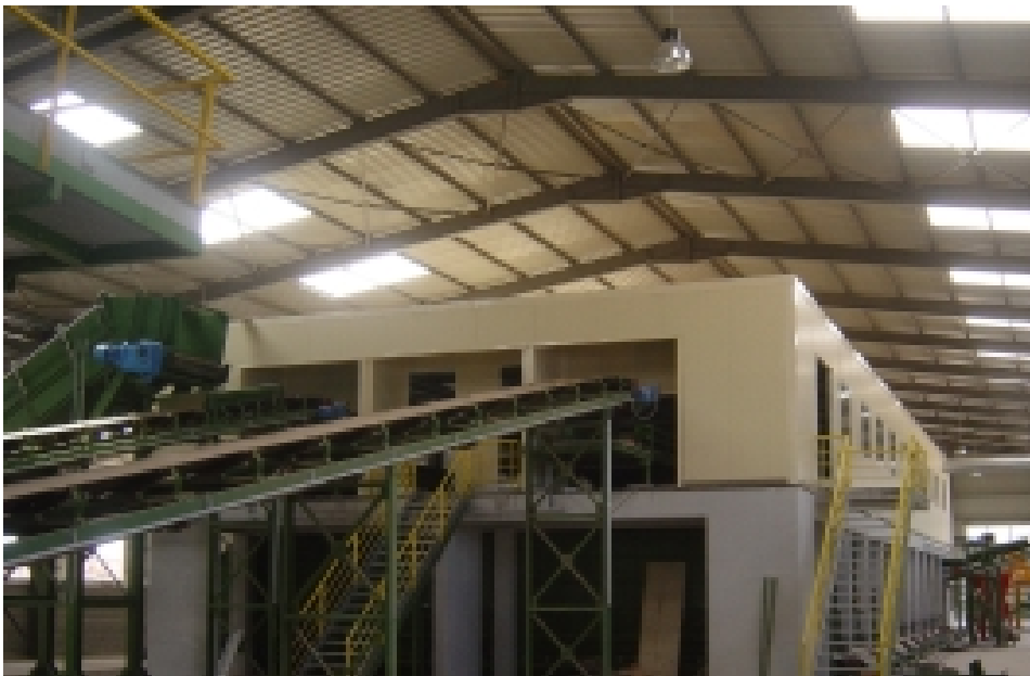
Εικόνα 5.3: Ταινία που οδηγεί τα ανακυκλώσιμα υλικά στο τμήμα της χειροδιαλογής
