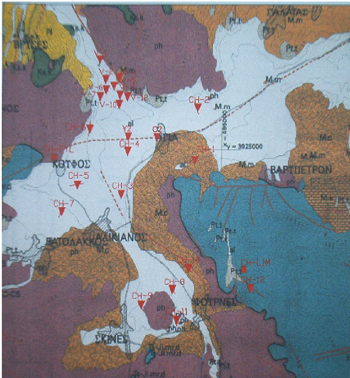
Σχήμα 20. Τοπογραφικός χάρτης και οι θέσεις των γεωηλεκτρικών βυθοσκοπήσεων, κλίμακα 1:50000
