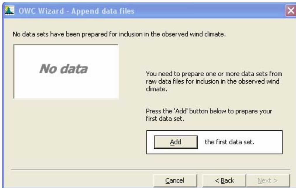
Σχήμα 6.4. Πιέζοντας την επιλογή Add μπορούμε να εισάγουμε το πρώτο αρχείο ανεμολογικών μετρήσεων (raw data).
