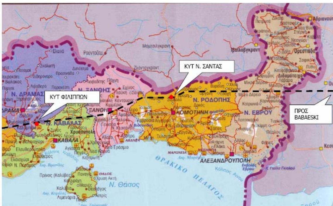
Σχήμα 3.2 : Οδευση έργων ενίσχυσης συστήματος μεταφοράς ηλεκτρικής ενέργειας στην περιοχή Ανατολικής Μακεδονίας και Θράκης.
