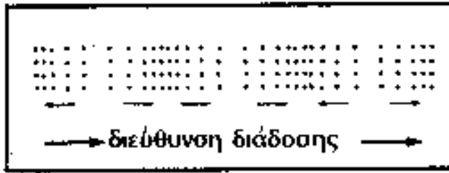
Σχήμα 9. Κινήσεις των υλικών σημείων κατά τη διάδοση επιμήκους κύματος.
