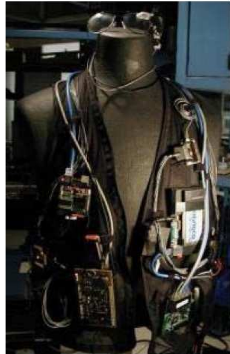
Σχήμα 11.2 Σχηματική Αναπαράσταση και Πρωτότυπη Υλοποίηση ενός Φορητού Υπολογιστή (από το MIT Media Lab)
