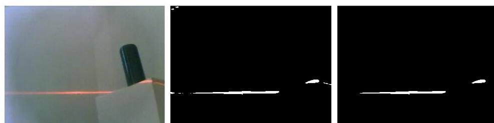
**Εικόνα 29β: Threshold με τιμή κατωφλιού 0.63.**
