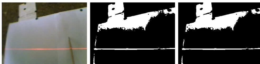
**Εικόνα 30α: Threshold με τιμή κατωφλιού 0.6.**
