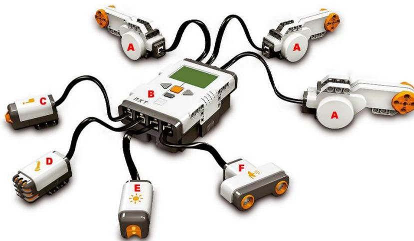
**Εικόνα 2: Βασικά μέρη που αποτελούν το πακέτο Lego Mindstorm NXT: A) σερβοκινητήρες, B) Μικροελεγκτής NXT, C) Αισθητήρας αφής, D) Αισθητήρας Ήχου, E) Αισθητήρας φωτός, F) Αισθητήρας υπερήχων.**
