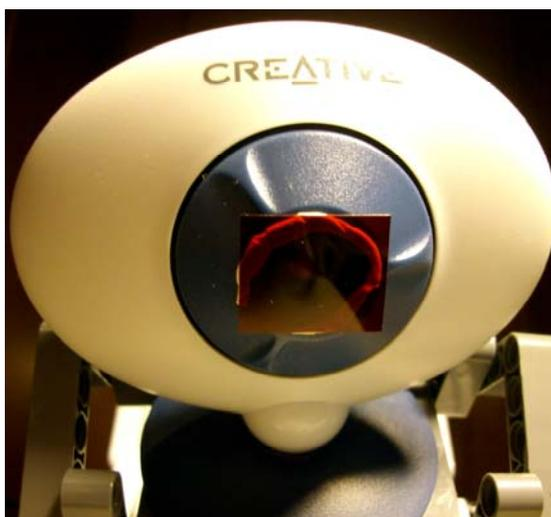
Εικόνα 51: Τοποθέτηση του φίλτρου στην κάμερα.
