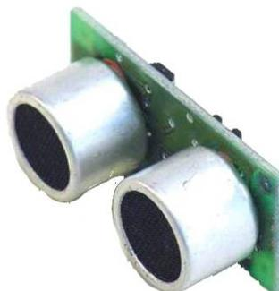
Εικόνα 13: Αισθητήρας υπερήχων.
