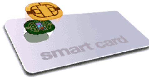
Εικόνα 3. Η δομή του chip πάνω στην κάρτα
