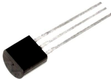
2.5 Αισθητήριο θερμοκρασίας LM 35.
