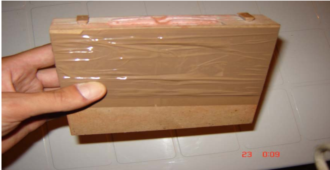
Εικόνα 1236: Τοποθέτηση ταινίας στο καλούπι
