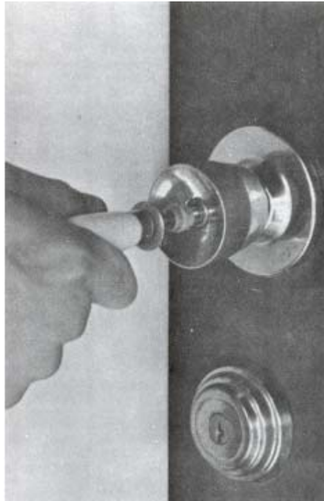
Εικόνα 91: Λειτουργία εργαλείου παραβίασης tubular κλειδαριών
