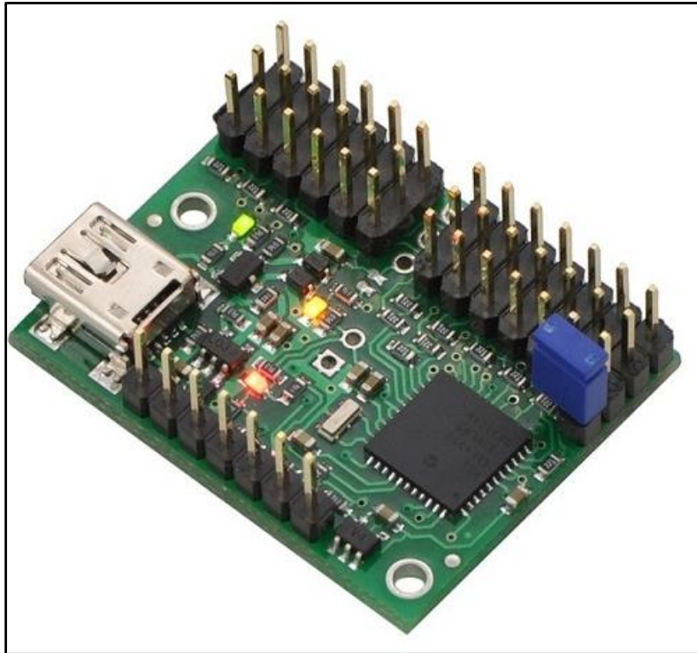
Εικόνα 19 : Servocontroller Pololu Mini Maestro 12
