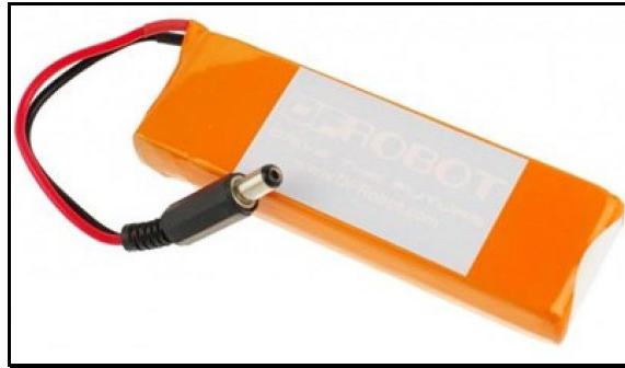
Εικόνα 11 : Μπαταρία Li-Poli 2200mAh
