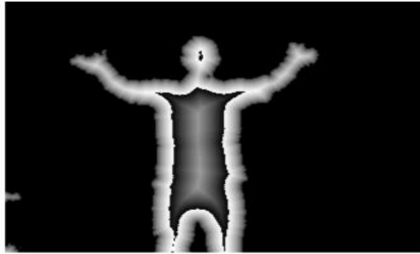
Εικόνα 28: Extended Distance Transform of a foreground segmented depth image
