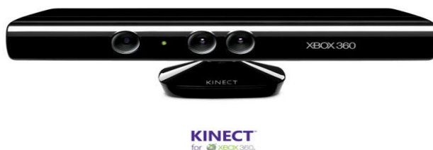
Εικόνα 10: Αισθητήρας Microsoft Kinect
