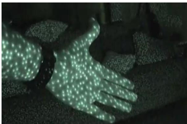
Εικόνα 15:Υπέρυθρη φωτογραφία που δείχνει τις κουκίδες laser που εκπέμπονται από το Kinect
