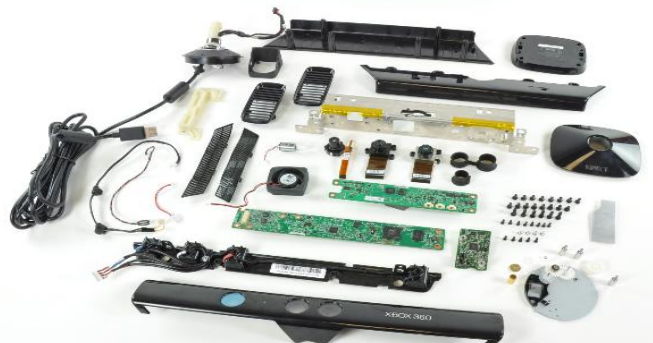
Εικόνα 12: Από το εσωτερικό εξοπλισμό του Kinect
