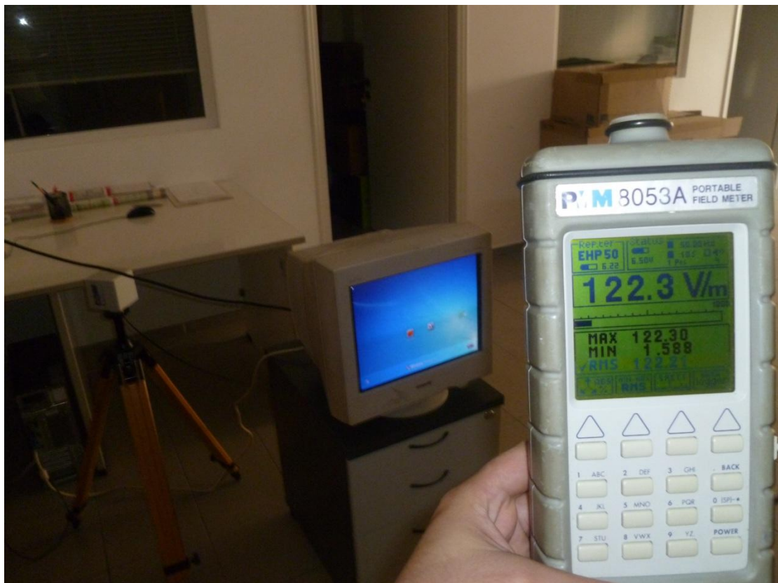
Μέτρηση ηλεκτρικού πεδίου χαμηλών συχνοτήτων με το πεδίομετρο και τον αισθητήρα - αναλυτή ηλεκτρικού και μαγνητικού πεδίου EHP-50C για το VDT σε γωνία \theta=225^\circ
