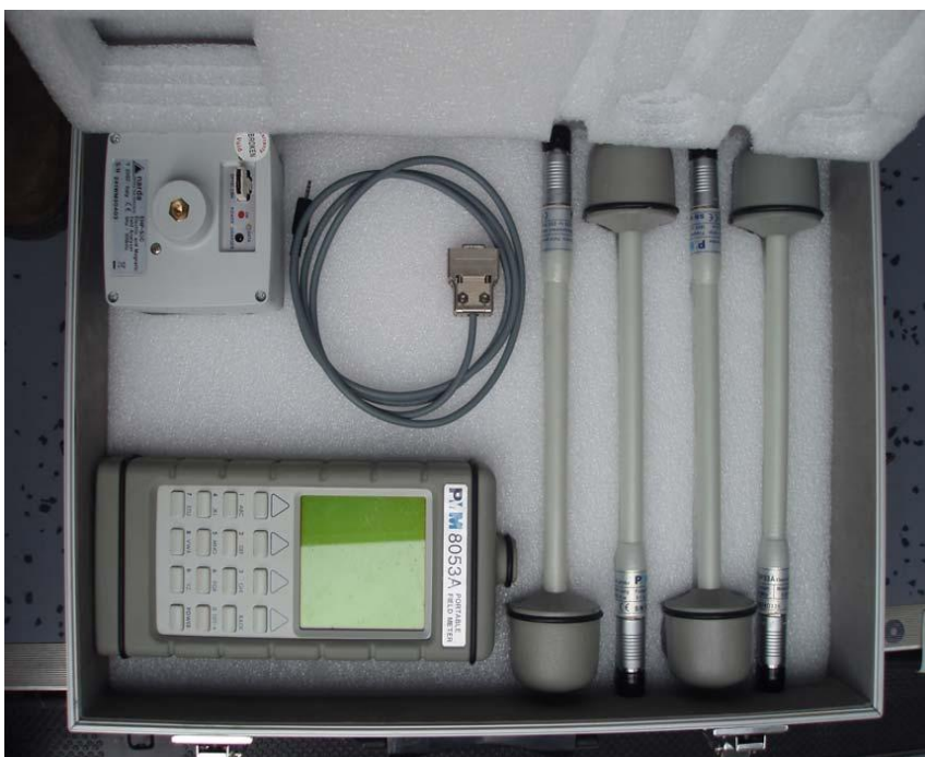
Το πεδιόμετρο PMM8053 του EMIA και ορισμένοι από τους διαθέσιμους αισθητήρες
