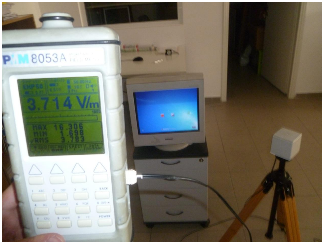
Μέτρηση ηλεκτρικού πεδίου χαμηλών συχνοτήτων με το πεδίομετρο και τον αισθητήρα - αναλυτή ηλεκτρικού και μαγνητικού πεδίου EHP-50C για το VDT σε γωνία \theta=45^\circ
