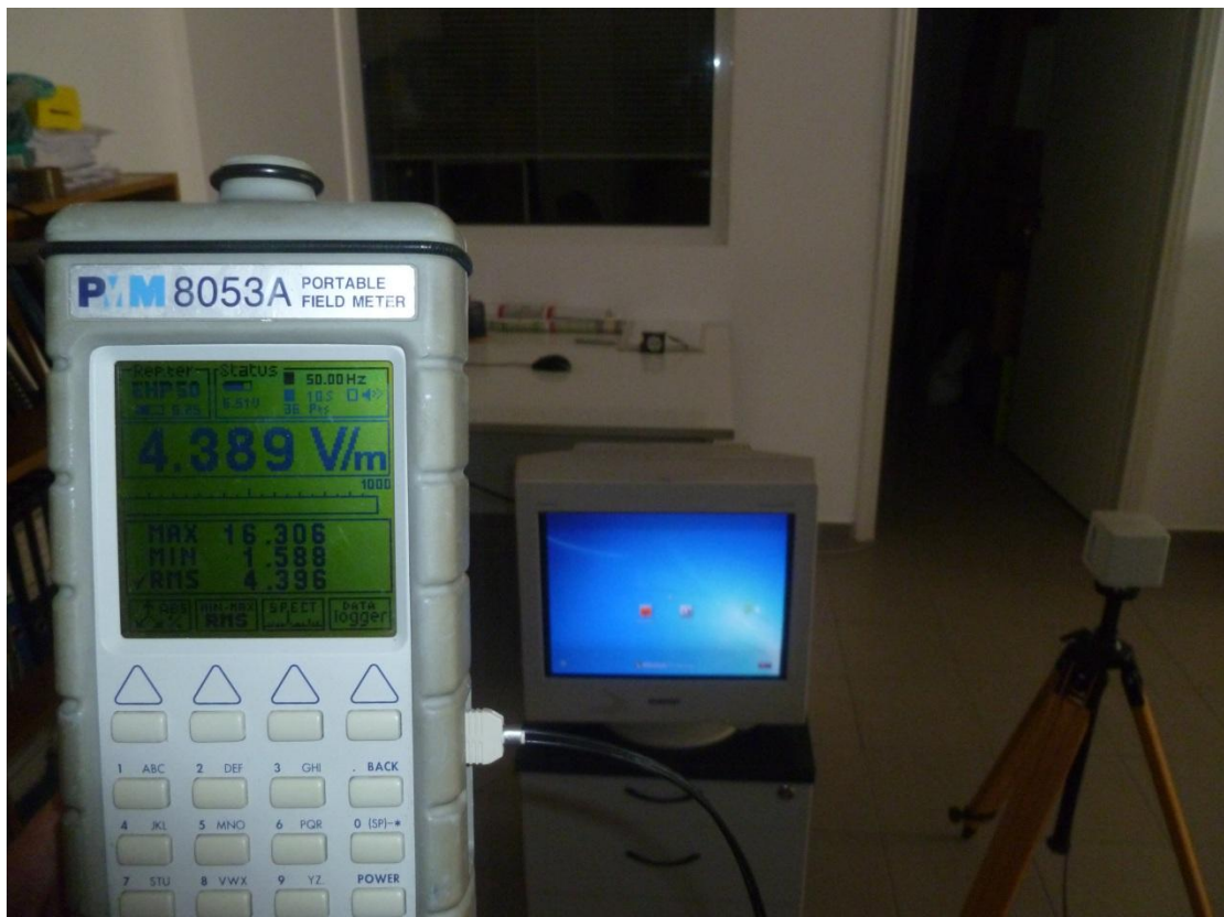
Μέτρηση ηλεκτρικού πεδίου χαμηλών συχνοτήτων με το πεδίομετρο και τον αισθητήρα - αναλυτή ηλεκτρικού και μαγνητικού πεδίου EHP-50C για το VDT σε γωνία \theta=90^\circ
