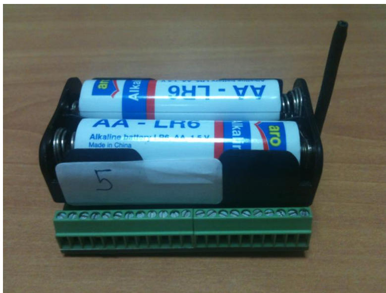
Εικόνα 27: MICAZ συνδεδεμένο με το MDA300CA
