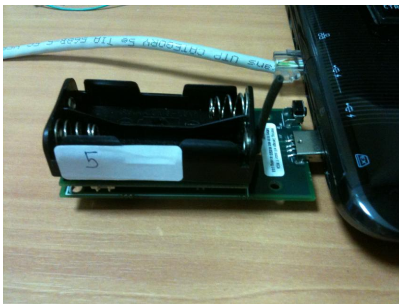
Εικόνα 28: MICAZ συνδεδεμένο με το MIB520CB
