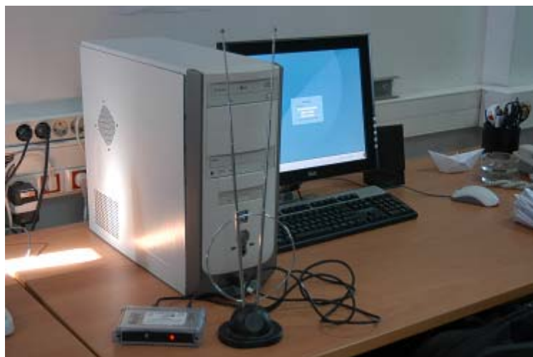
Σχήμα 3.8 Ενδιάμεσος Κόμβος Διανομής (CMN), κάρτα επίγειας ψηφιακής τηλεόρασης, κεραία λήψης
