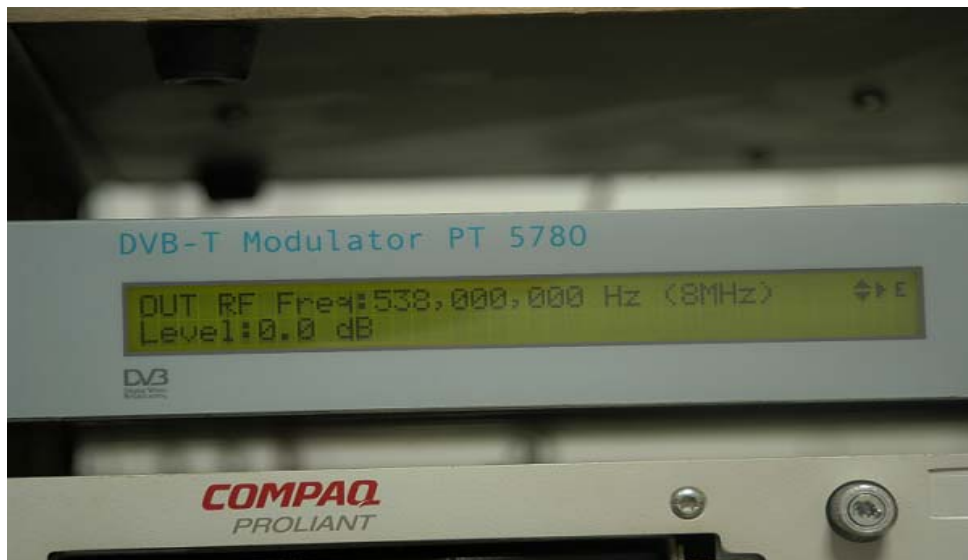
Σχήμα 3.2 Ο διαμορφωτής COFDM που παρέχει το DVB-T stream στο κανάλι 29 σε επίπεδο δύναμης 0dBm
