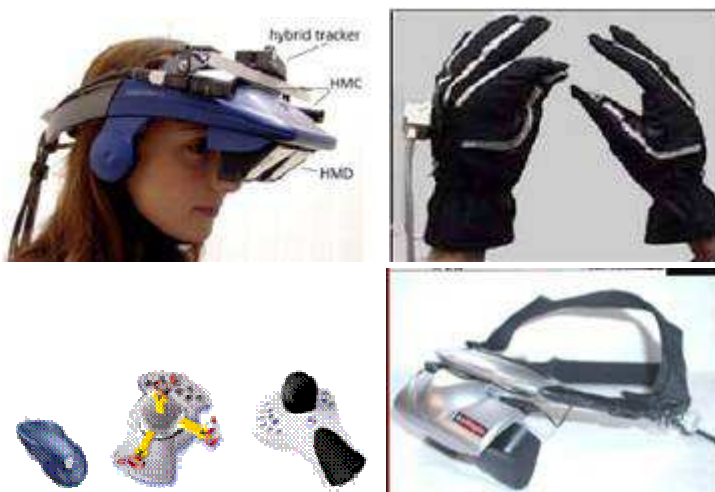
Εικόνα 8:Συσκευές εικονικού περιβάλλοντος: α) ένα σύγχρονο HMD, β) γάντια δεδομένων, γ) απλό και τρισδιάστατο ποντίκι και τρισδιάστατο ποντίκι και τρισδιάστατη σφαίρα
