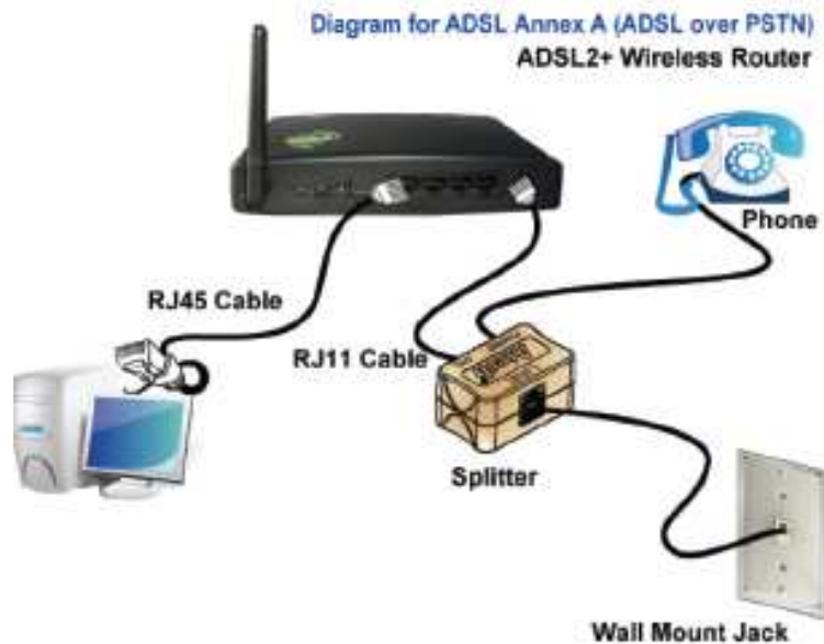
Εικόνα 10.2: Σύνδεση του ADSL2+ Router με PSTN τηλεφωνική γραμμή
