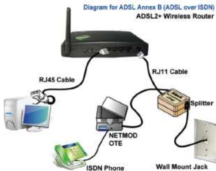
Εικόνα 10.1: Σύνδεση του ADSL2+ Router με ISDN τηλεφωνική γραμμή
