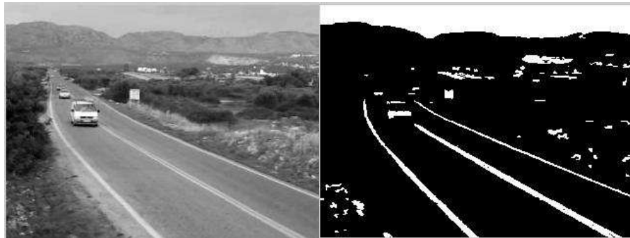
Σχήμα 1. Το άσπρο χρώμα του ουρανού δημιουργεί πρόβλημα στον εντοπισμό του αυτοκινήτου
