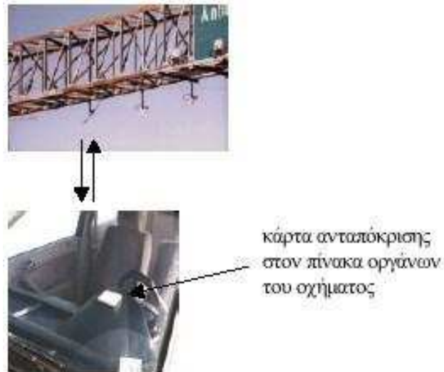
Εικόνα 12. Λειτουργία συστήματος παρακολούθησης με κάρτες ανταπόκρισης οχημάτων
