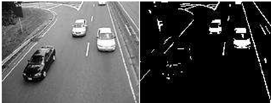
Σχήμα 2. Σφάλμα εντοπισμού μαύρου αυτοκινήτου
