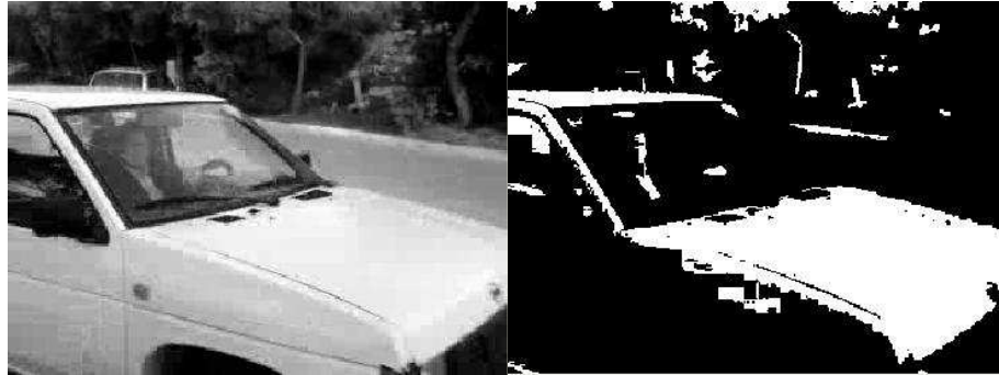
Σχήμα 3. Σφάλμα εντοπισμού και των δύο αυτοκινήτων λόγω κακής λήψης της κάμερας
