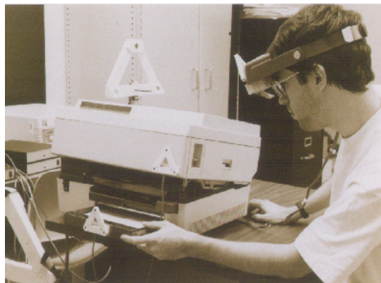
Εικόνα 2.7: Εκτυπωτής laser στον οποίο όλα τα αντικείμενα έχουν εντοπιστεί προκειμένου να λειτουργήσει το σύστημα επαυξημένης πραγματικότητας για τη συντήρηση του.
