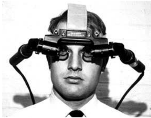
Εικόνα 2.1: See-through CRT γυαλιά
