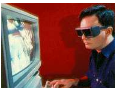
Εικόνα 2.14: Εξωτερική όψη του συστήματος Argos, ένα σύστημα Ε.Π. βασισμένο σε οθόνη (Courtesy David Drascic and Paul Milgram, U. Toronto.)
