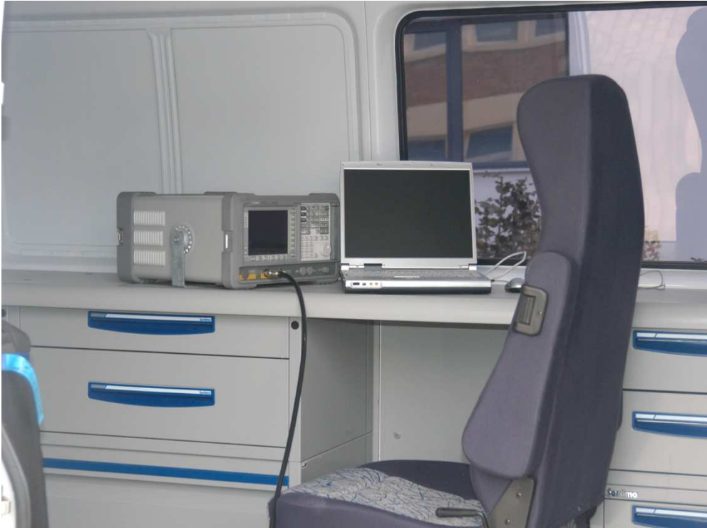
Εικόνα 10 : Φασματικός αναλυτής και Laptop συνδεδεμένα μπροστά από την θέση εργασίας εντός του οχήματος του Ε.Μ.Ι.Α.
