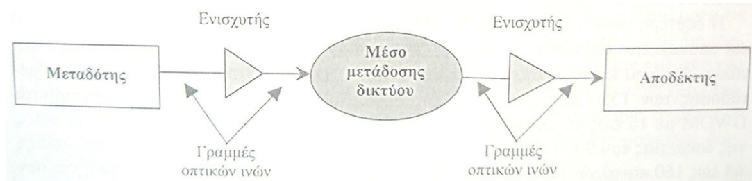
Εικόνα 6.2. Βασική δομή δικτύου με μεταδότη και αποδέκτη.
