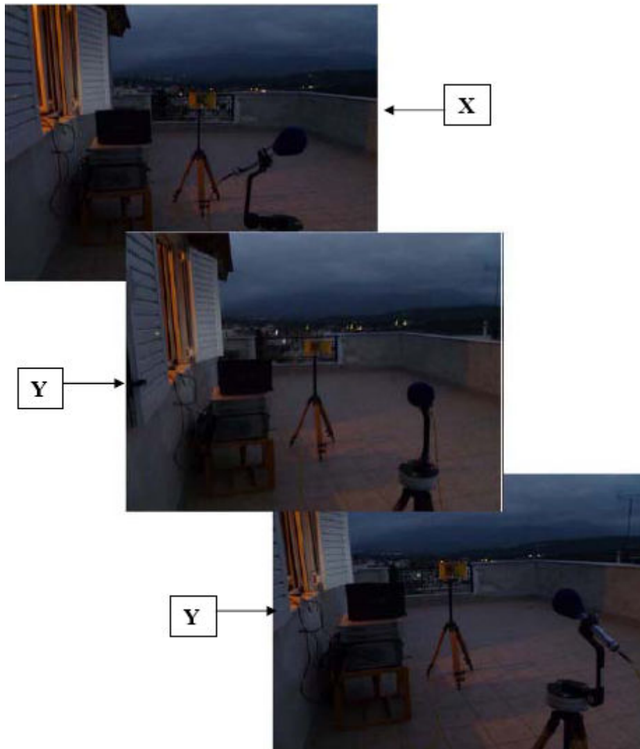
Εικόνα 28 : X, Y και Z κατευθύνσεις της διπολικής κεραίας sPOD16 για την διενέργεια μετρήσεων
