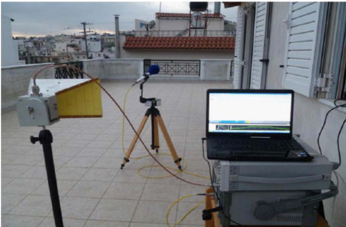
Εικόνα 11 : Συνδεσμολογία στην πράξη για εκπομπή και λήψη WiMAX σήματος.
