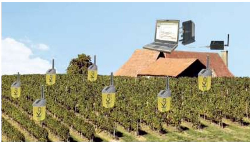
Εικόνα 41: Ασύρματο δίκτυο αισθητήρων eKo για παρακολούθηση και έλεγχο καλλιεργειών
