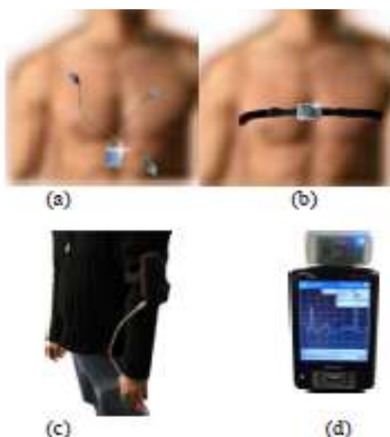
Εικόνα 65: (a) Ασύρματοι αισθητήρες ECG, (b) λουρί ECG, (c) SpO2 αισθητήρας, (d) ο σταθμός PDA.
