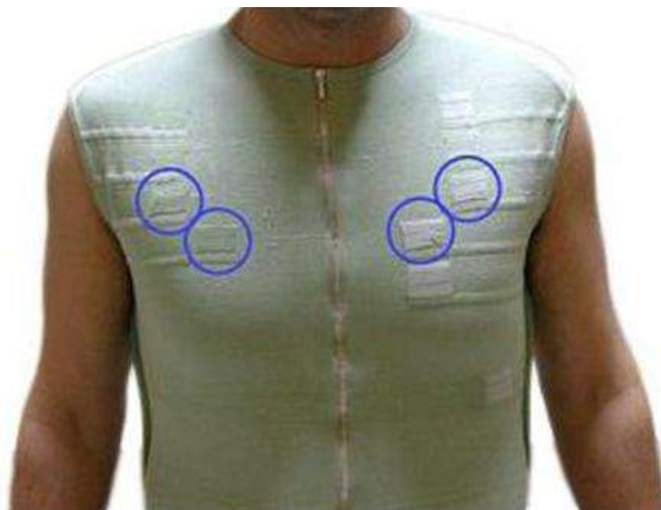
Εικόνα 24 : Θέση ηλεκτροδίων για τη μέτρηση της αναπνοής μέσω αντίστασης πνευμόνων
