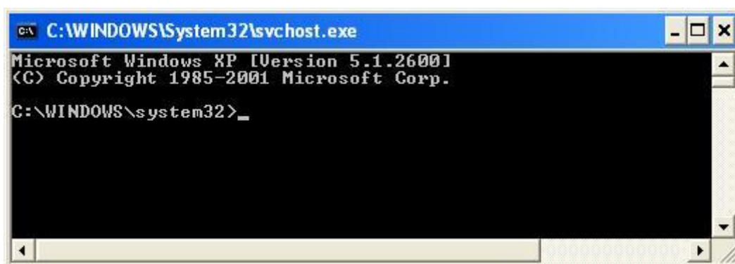
Εικόνα 82:Σύνδεση εξ αποστάσεως με δικαιώματα System
