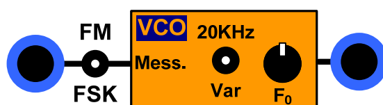
Σχήμα 67: Κύκλωμα διαμόρφωσης συχνότητας της εργαστηριακής πλακέτας.
