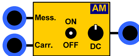
Σχήμα 30: Διαμορφωτής AM εργαστηριακής πλακέτας.
