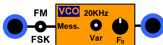
Σχήμα 50: Κύκλωμα διαμορφωτή συχνότητας της εργαστηριακής πλακέτας.
