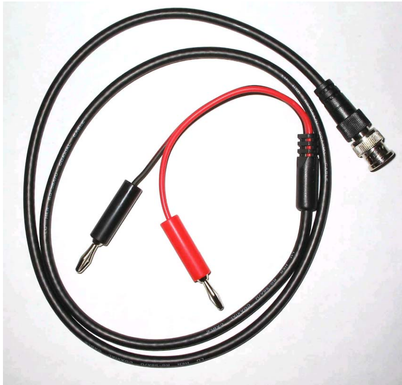
Εικόνα 2: Καλώδιο σύνδεσης εργαστηριακής πλακέτας με τροφοδοτικό.
