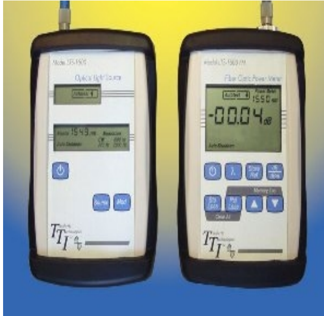
Εικόνα 104 : Μετρητές ισχύος οπτικών ινών
