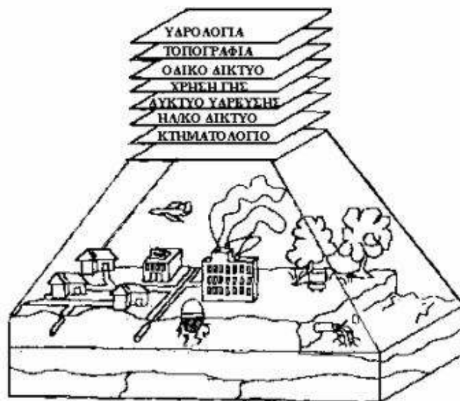
Σχήμα 6: Τα στοιχεία του πραγματικού κόσμου αναπαρίστανται σε διαφορετικούς αλληλεπικαλυπτόμενους θεματικούς χάρτες (layers)
