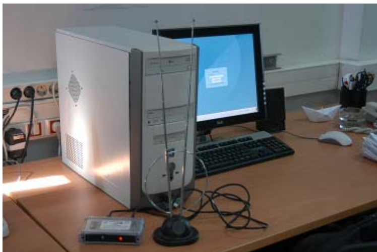
Σχ. 3.5 Ενδιάμεσος Κόμβος Διανομής (CMN), Κάρτα Επίγειας Ψηφιακής Τηλεόρασης, Κεραία Λήψης
