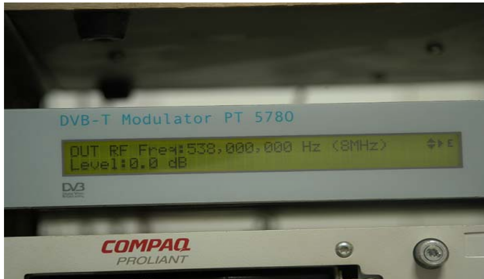
Σχ. 3.3 Ο Διαμορφωτής COFDM που Παρέχει το DVB-T Stream στο Κανάλι 29 σε Επίπεδο Δύναμης 0dBm
