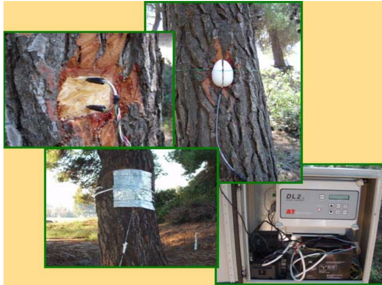
Εικόνα 18. Ζεύγος αισθητήρων μέτρησης ροής χυμών TDP80, DYNAMAX Inc., U.S.A.
