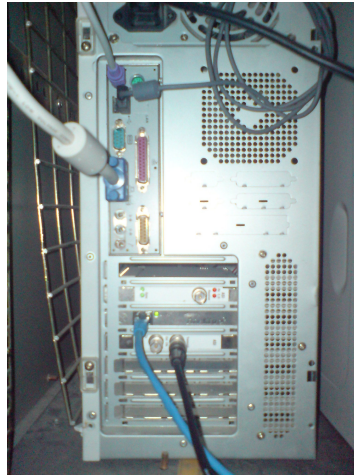
Σχήμα 6.1: Η είσοδος δικτύου και η ASI έξοδος του ULE ενθυλακωτή.
