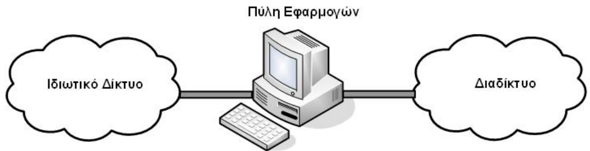
Σχήμα 8-2: Τοποθέτηση μιας πύλης εφαρμογών μεταξύ ενός ιδιωτικού δικτύου και του διαδικτύου
