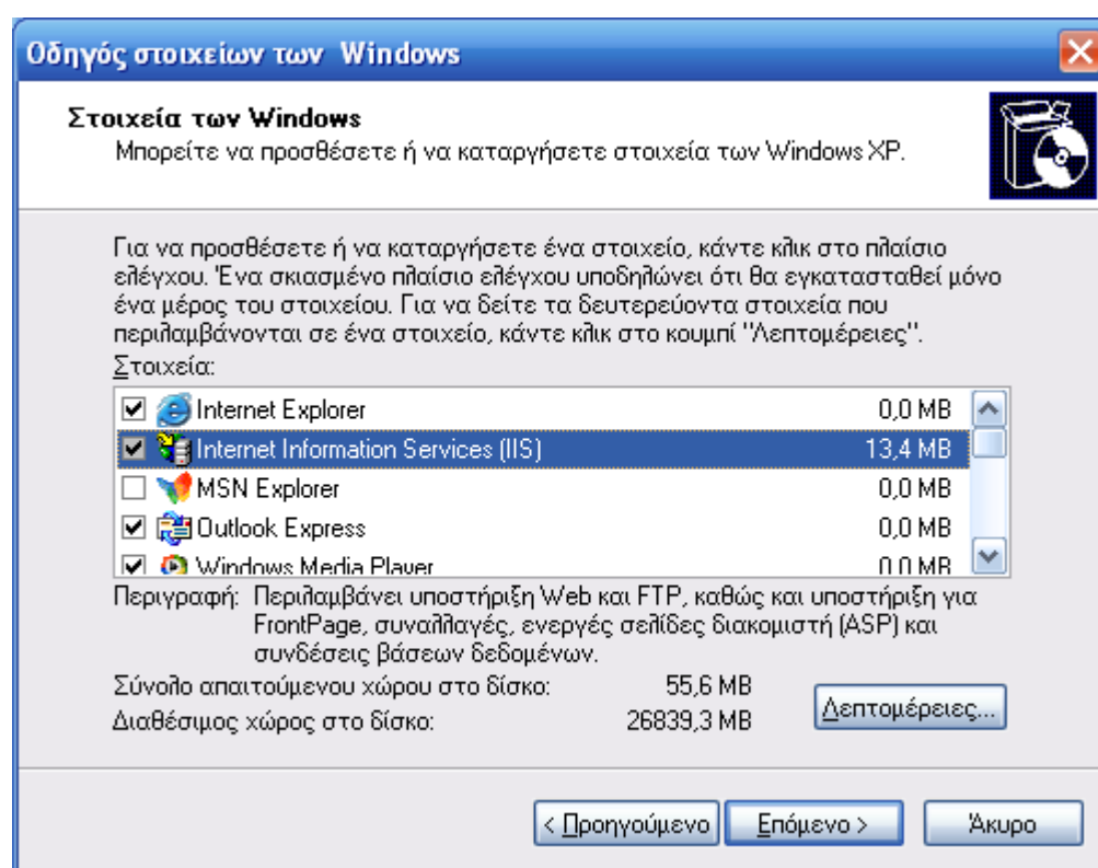
Εικόνα ΠΒ1: Εγκατάσταση του IIS
