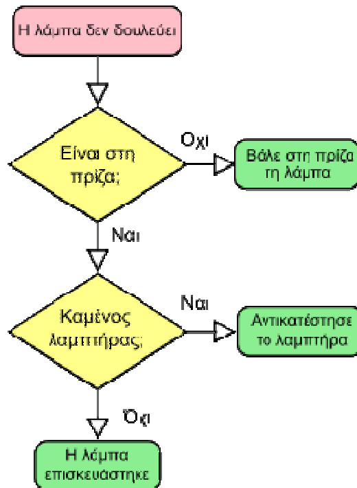
Εικόνα 1: Ένα απλό διάγραμμα ροής, το οποίο απεικονίζει τον αλγόριθμο ελέγχου και επισκευής μιας λάμπας η οποία δεν δουλεύει.
