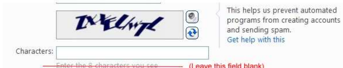
Εικόνα 4-5 Ένα πρωτότυπο CAPTCHA αναγνώρισης γραμμάτων, το οποίο αφού παρουσιάζει του πρόβλημα λέει στους χρήστες να το αγνοήσουν. Παρόλα αυτά είναι πιθανό πολλοί χρήστες να συμπληρώσουν το πεδίο από συνήθεια χωρίς να διαβάσουν τις οδηγίες
