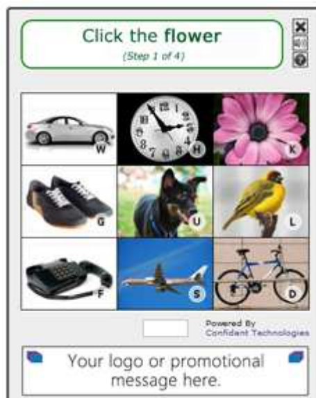
Εικόνα 4-9 Ένα τυπικό CAPTCHA αναγνώρισης εικόνας. Ο χρήστης πρέπει να επιλέξει το αντικείμενο που του ζητείται στην ερώτηση που έχει τεθεί. Για να αποφευχθεί η τυχαία επιλογή μίας εικόνας κατά την προσπάθεια επίλυσης το συγκεκριμένο τεστ θέτει στον χρήστη τέσσερις ερωτήσεις, μειώνοντας δραματικά τις πιθανότητες επίλυσης.
