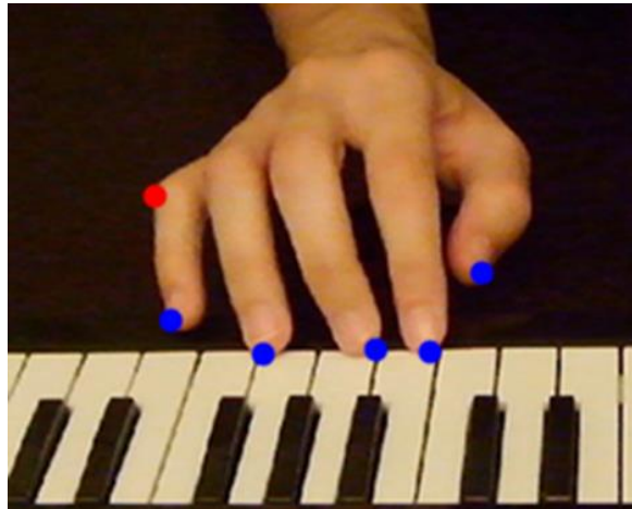
Εικόνα 6.6: Αφαίρεση λανθασμένα εντοπισμένου ακροδαχτύλου
