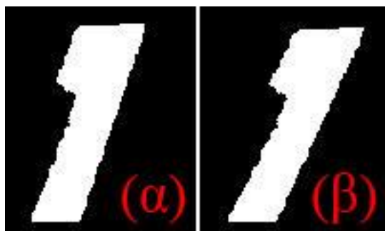
Εικόνα 7.3: Πλήκτρο μακριά από το κέντρο της εικόνας (α) Η αρχική του κατάσταση (β) Η κλίση που αποκτά όταν βρίσκεται υπό πίεση
