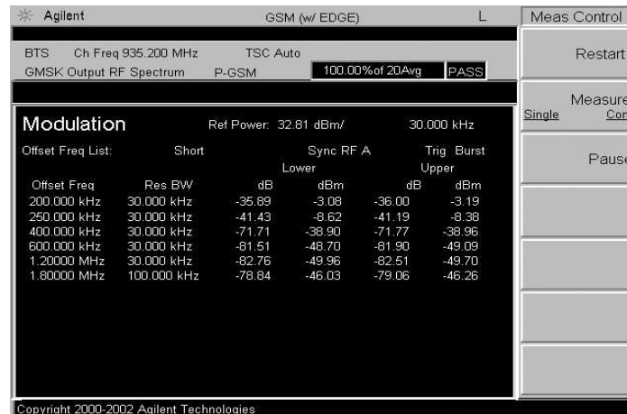
Εικόνα 38. Φάσμα λόγω της διαμόρφωσης που παρουσιάζεται στη συσκευή ανάλυσης φάσματος σειράς Agilent E4440A PSA
