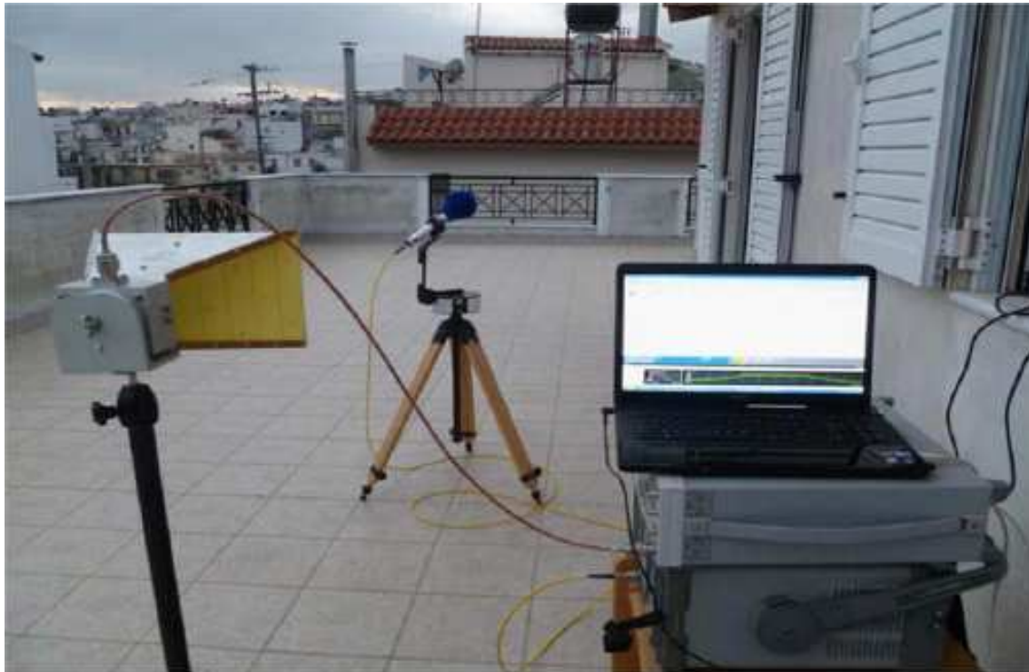
Εικόνα 99 : Συνδεσμολογία στην πράξη για εκπομπή και λήψη WCDMA σήματος.
