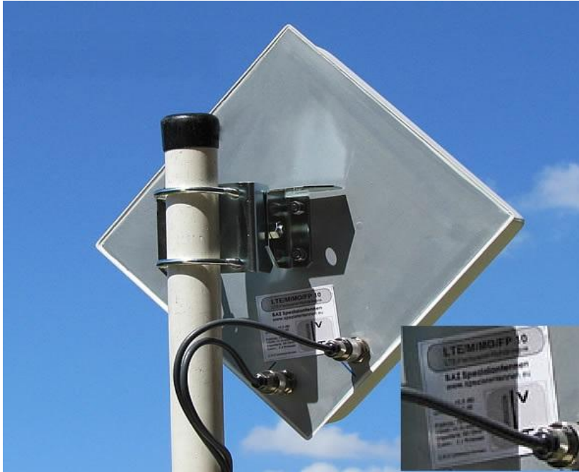
Εικόνα 3.4 Έξυπνη κεραία MIMO.
