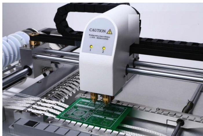
Εικόνα 2. 25 Ρομπότ δημιουργίας ηλεκτρονικών κυκλωμάτων με την μέθοδο pick-and-place
