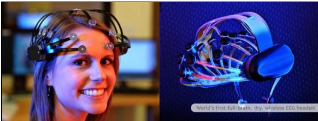
Εικόνα 1: Πρώτο full-brain ασύρματο EEG headset
