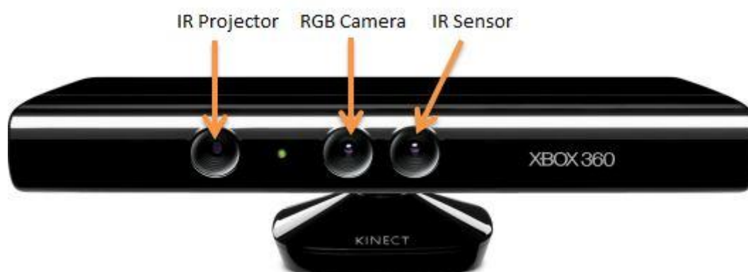
Εικόνα 1. Δομή συσκευής Kinect, Πηγή: Ιστοσελίδα Xbox, Kinect για το Xbox 360
