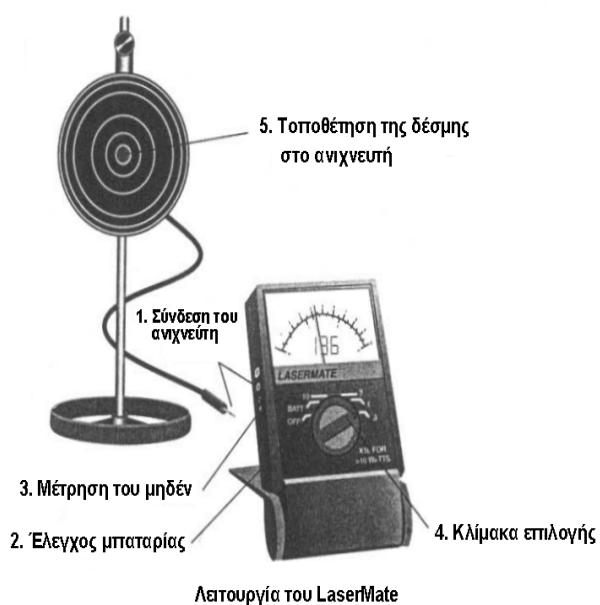
Εικ.4.28: Σύστημα καταγραφής ισχύος laser
