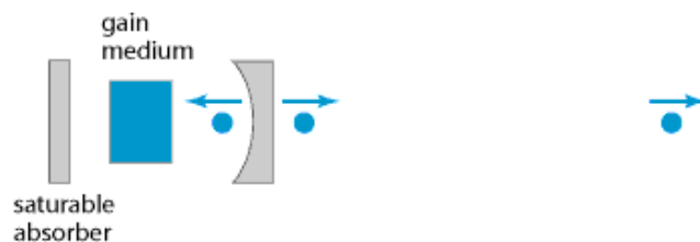
Εικ.3.25: Σχηματική δομή laser παθητικής εγκλειδωσης ρυθμών.
