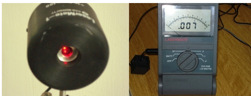
Εικ.4.29: Μέτρηση οπτικής ισχύος διοδικού laser.
