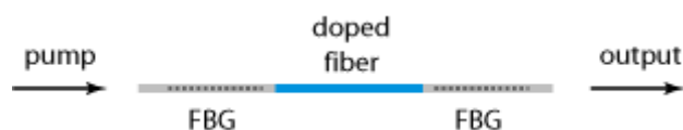
Εικ. 3.4: Μικρού μήκους DBR laser ίνας για εκπομπή περιορισμένου εύρους πλάτος δέσμης.
