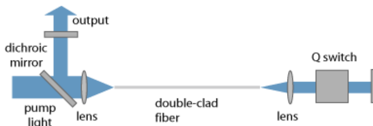
Εικ.3.22: Δομή ενεργού laser ίνας μεταγωγής-Q.
