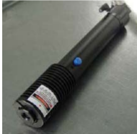
Εικ.4.9: Laser Module Μοντέλο PGL-III-660/100~300 mW.
